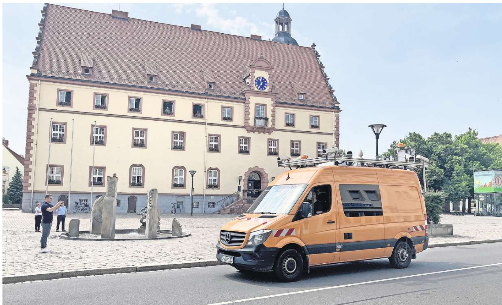
Acht Kameras und zwei Scanner auf dem Messfahrzeug erfassen die Fahrbahn und den Straßenraum.
